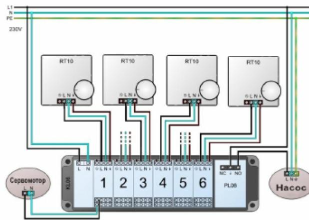
Каждая секция подключение к 4 сервомоторам
