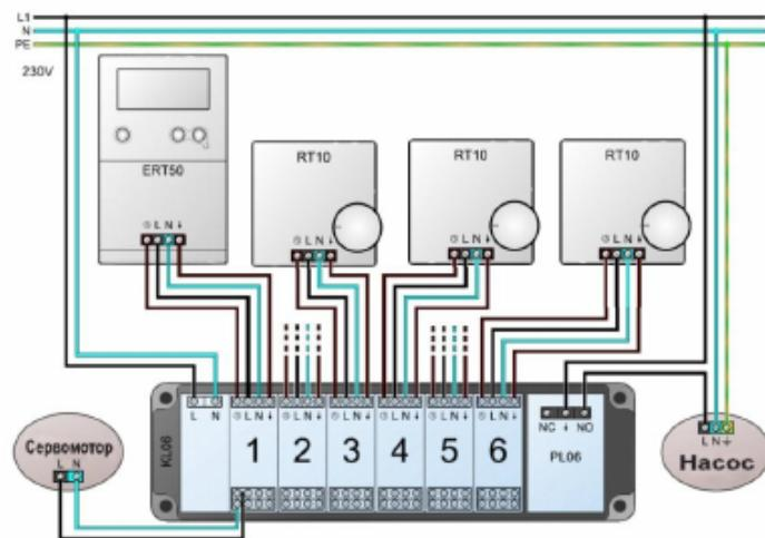
**Схема подключения 2**
